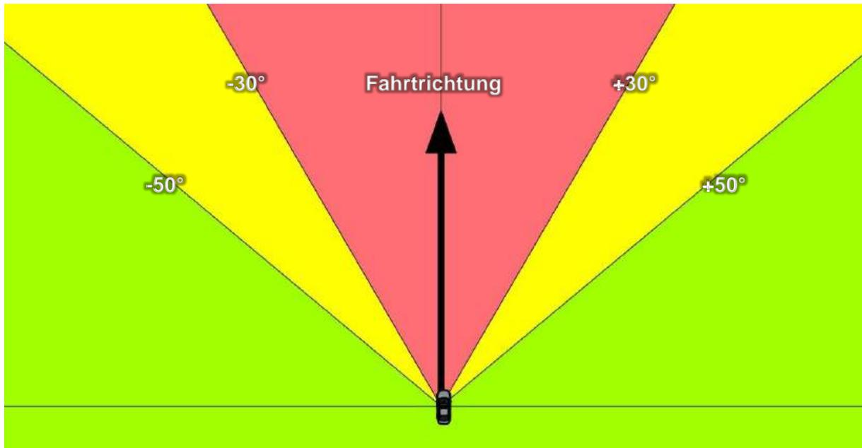
Abbildung 10: Definierte Sichtfelder eines Fahrzeugführers
