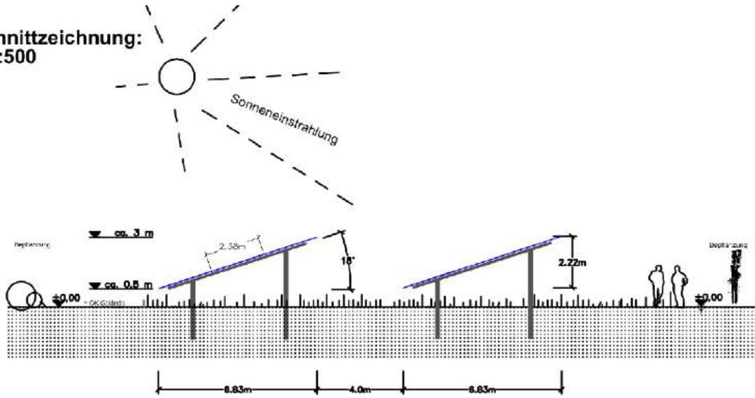
Abbildung 3: Systemschnitt der Modultische - Quelle: Auftraggeber
