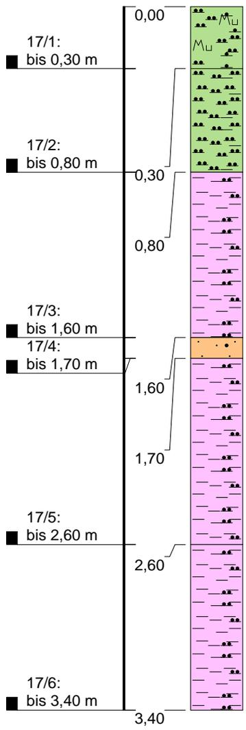
0,30 Schluff, schwach feinsandig, schwach tonig, organisch, Mutterboden, dunkelbraun, schwach feucht, leicht plastisch, weich, leicht zu bohren, OH (Grob-/gemischtkörnige Böden, humos), Rammkernbohrung D=60mm bis 1,0m
