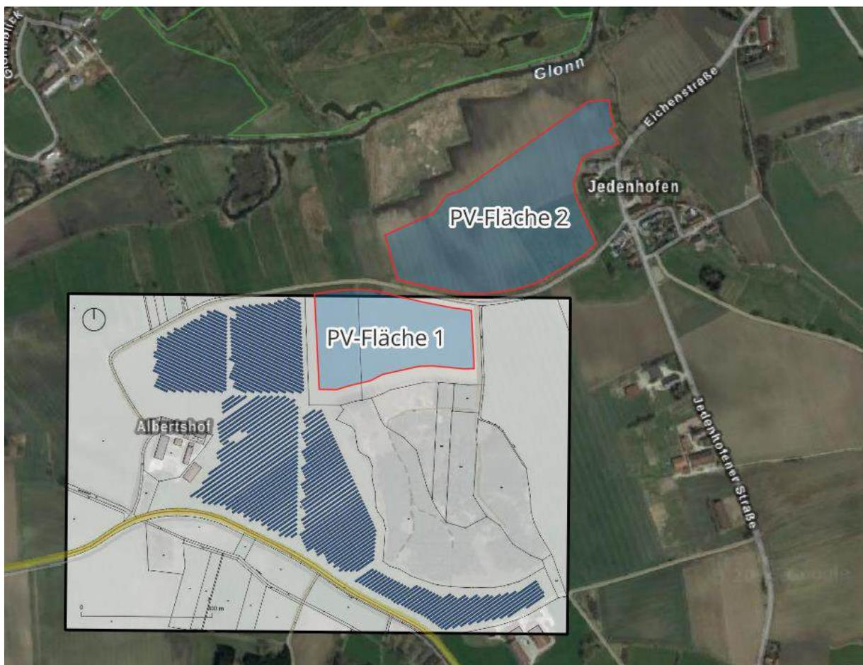
Abbildung 15: Positionen der geplanten PV-Parks: Der Grundriss der PVA Jedenhofen ist in Rot mit blauer Füllung dargestellt. Die Modultische des Energieparks Weichs sind als blaue Rechtecke dargestellt.
