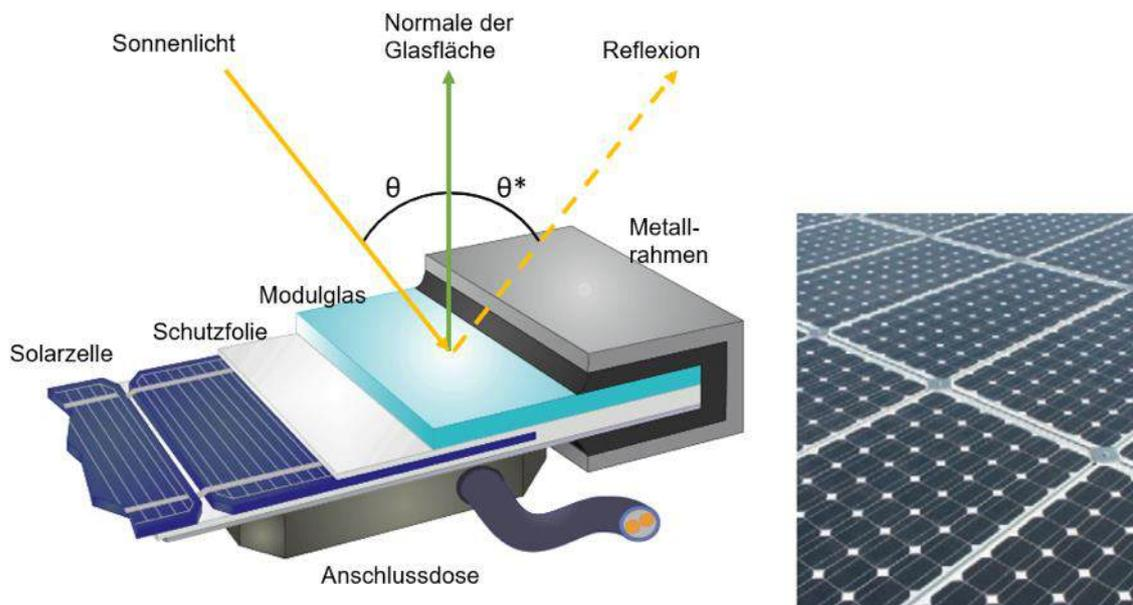
Abbildung 4: Aufbau eines PV-Moduls und Darstellung des Reflexionsgesetzes „Einfallswinkel = Ausfallswinkel“
