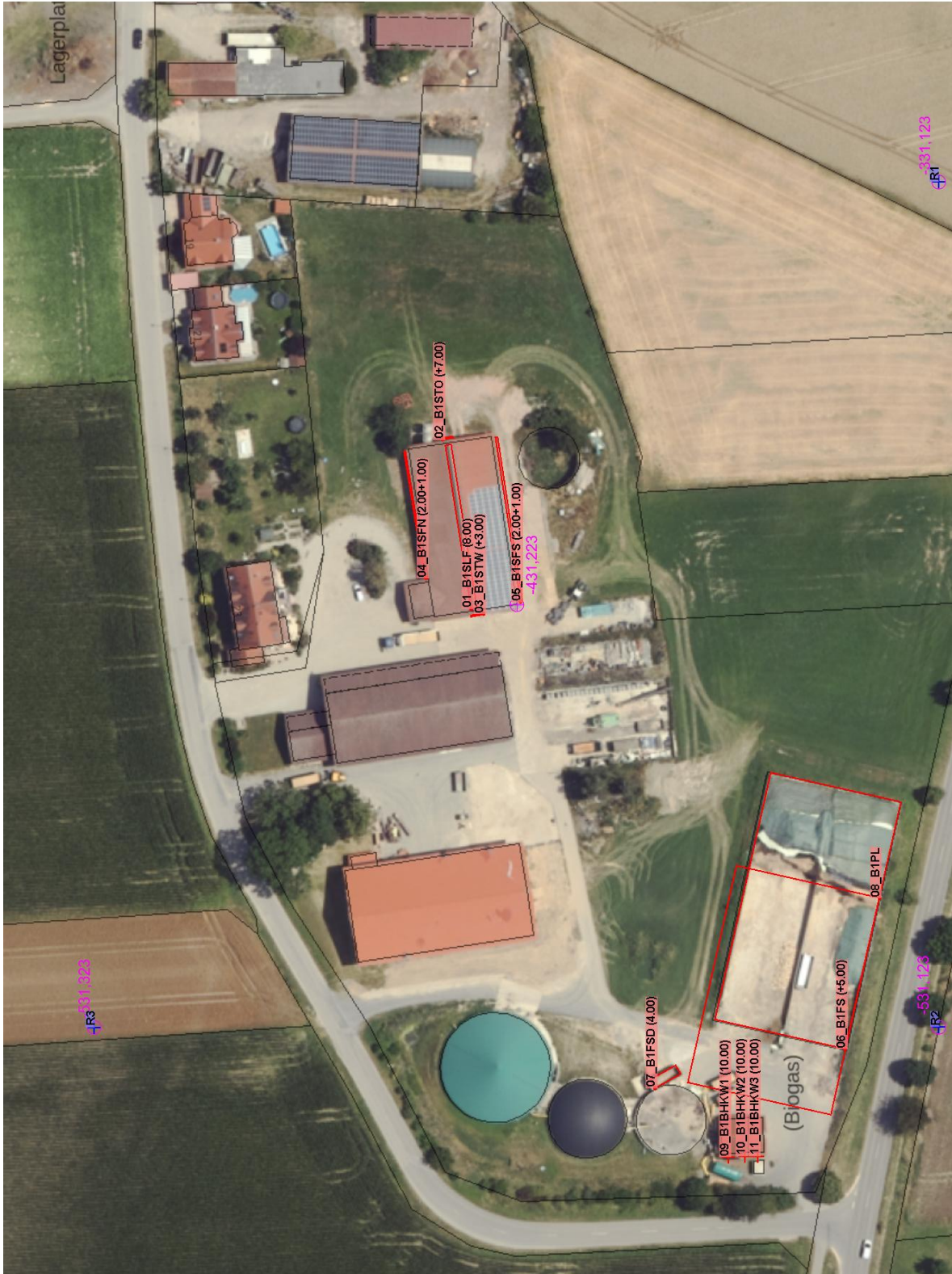
Abbildung A1-3: Lage der Emissionsquellen (rot) am Betrieb 1 BGA und RH. Hinweis: Die Abbildung ist um 90° nach links gedreht. Norden befindet sich am linken Bildrand.
