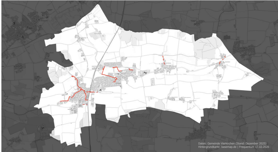
Abb. 5: Verlauf des Abwasserkanalnetzes (> 800DN) in Vierkirchen.
