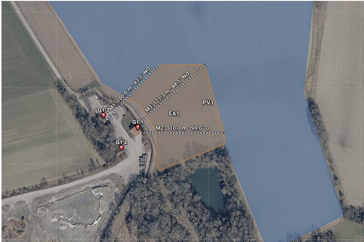
Abbildung 21: Orangefarbener Bereich: Aussparen oder blendarme Module verbauen
